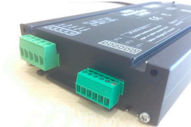
*NOTA:* En la fotografía se muestra el conector de entrada de tensión y el de entrada de los sensores de corriente.
